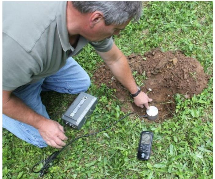
technologie permet à son utilisateur de choisir des séquences de délai de minutage par millisecondes qui réduiront la vitesse de crête des particules et augmenteront les Hz pour les divers sites de dynamitage à la carrière et leurs lieux précis de monitoring par sismographe.
